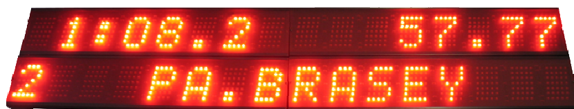
Vier HL 980 Displays mit Zeit des Teilnehmers und Abstand in Bezug auf die Bestzeit, Teilnehmernummer und Name
